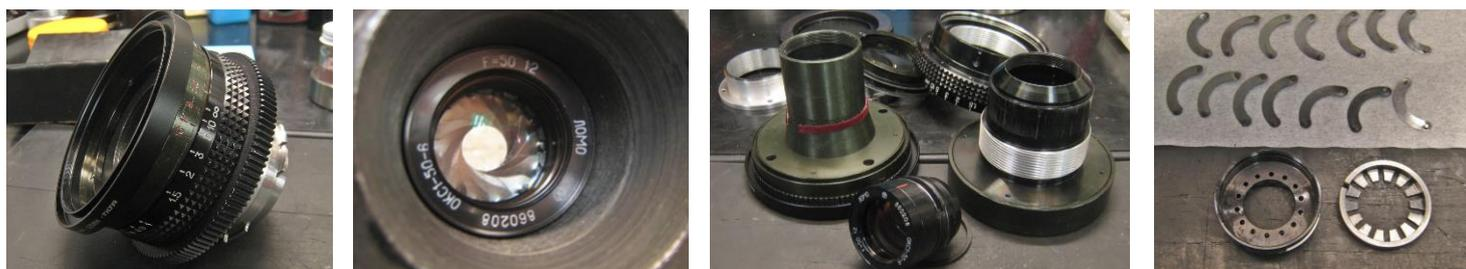
作業内容:アイリス機構分解、折れ曲がったアイリス羽根・摩耗回転バレルの修復、グリスアップ。
