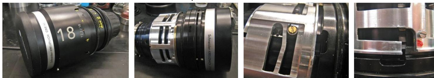
作業内容:フォーカス機構分解、変形部品の修復及び、アルマイト処理、グリスアップ。光学調整。アイリス機構分解清掃。
