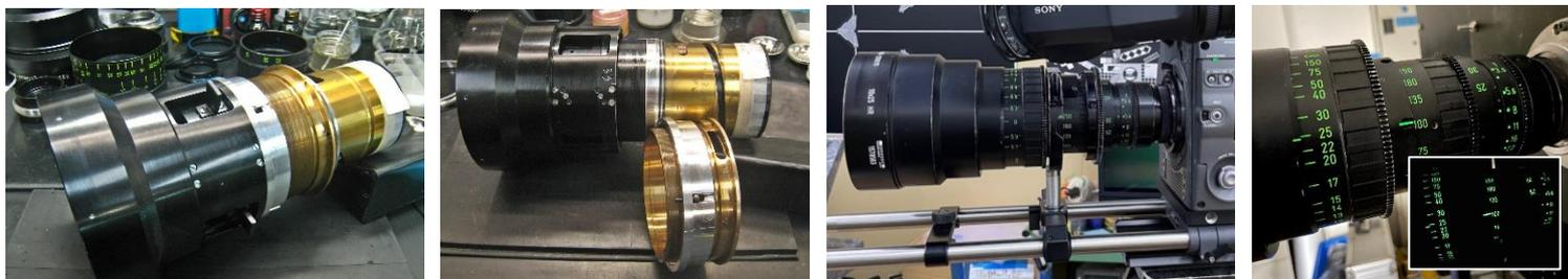
作業内容:フォーカ・ズーム・アイリス各機構の分解清掃・グリスアップにより各部の動作改善。光学調整によりピント流れ・片ボケ補正。指標の再塗装。各部清掃。
