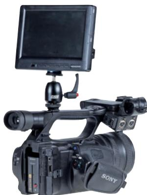
上の写真のような組み合わせでは、雲台下部のナットはカメラ側にロックし、雲台上部のナットはモニター側にロックします。この雲台は、ライティングやモニターなどのUNC1/4"ねじの付いたアクセサリーの他にホットシュー関連の機器やカメラ回りの撮影用機材を映像用カメラに装着する役目を果たします。
